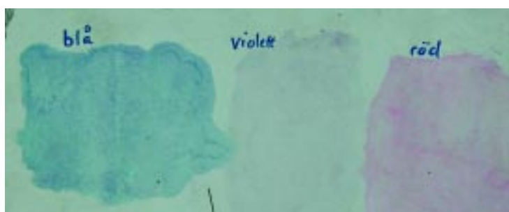
Figur 3. Element med titanoxidbruk som ytmaterial.
