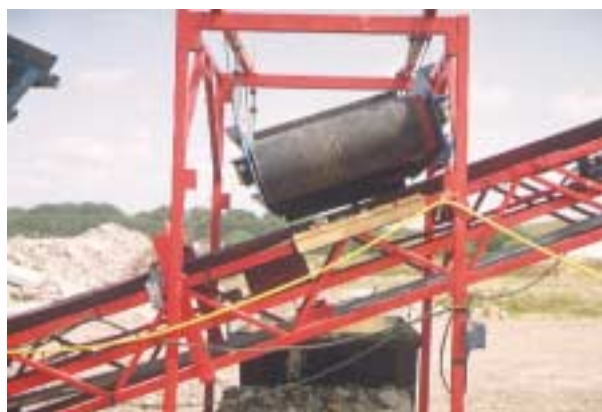
Magnetband som sorterar bort de sista resterna av armeringsjärnen.
