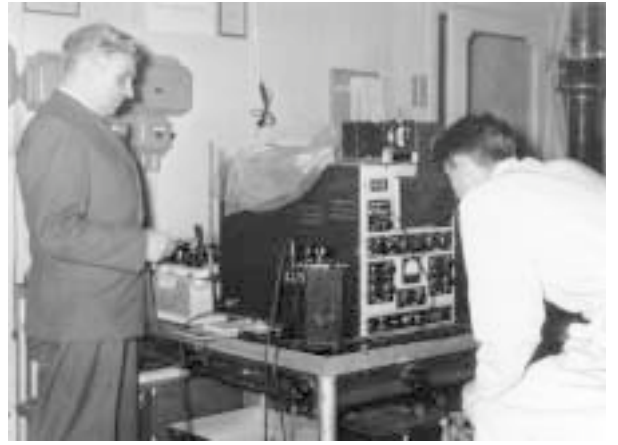
Mätning av provbalkars egenfrekvens, kapten Verendel och ing Wastesson.
