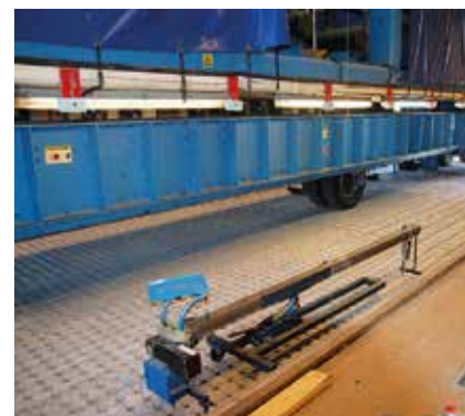
Fullskaleprovning med s.k. Heavy Vehicle Simulator hos VTI (nedan).
