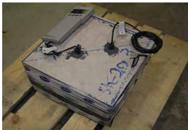
Bild 2. Betongblock (dotterblock) med två stycken svarta nedsänkta plaströr för mätning av fukthalt (RF). Ett medelvärde av den relativa fukthalten beräknas utifrån de två mätningarna. Mätinstrument från Vaisala vilandes på betongblocket i övre vänstra hörnet av blocket.
