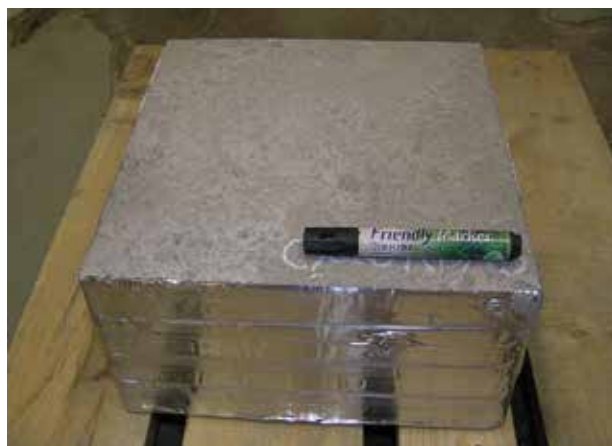
Bild 1. Radongasprov av betong. Storleken är 0,3 \times 0,3 \times 0,15 m. Betongblocket är omslutet av aluminiumtejp för att endast radonavgång skall ske från ytan.
