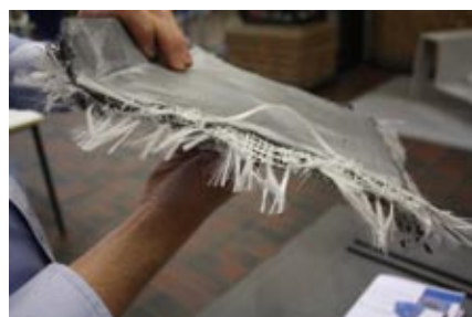
Exempel på textilarmerad betong (tjocklek 5 mm).
