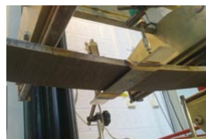
Böjdragsprovning av 10 mm tjock textilarmerad betongskiva.
