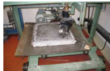
Figur 1. Provning med rullande hjul (Bring metoden) på en pågjutning på en av de stora plattorna.
